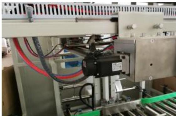
该机采用多伺服控制，通过胶膜机构，自动将袋子撑开，输入箱中，速度快，封切准，套袋稳。
