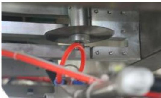
滚轮切刀采用无杆气缸控制，节省空间，实现滚轮切刀往复运动。封切时封口不开裂、不焦化、不冒烟，零污染，套袋贴实，平整美观。
